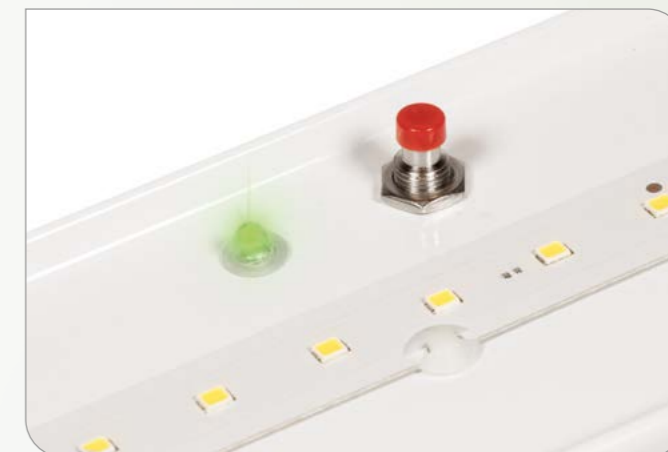
Dioda LED wskazująca stan jednostki awaryjnej + przycisk sterowania testem ręcznym
